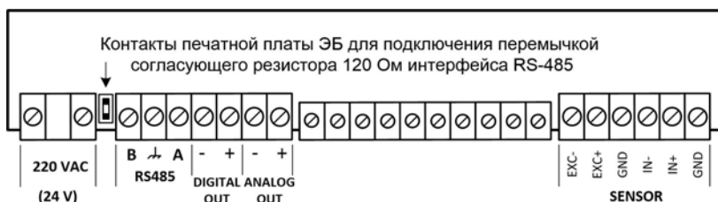
Рисунок Г.1 – Расположение контактов на клеммной колодке ЭБ (отдельное исполнение, перемычка для согласующего резистора не установлена)
