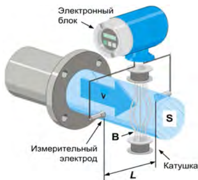
Рисунок 3.1 – Пояснение работы электромагнитного сенсора (расстояние между концами измерительных электродов соответствует диаметру трубы:
